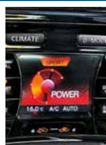
Dodatkowy ekran wyświetla dane z silnika lub aktualne ustawienia klimatyzacji.
