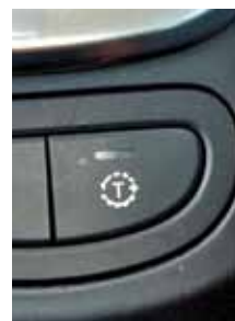
Atrybut Trekkinga, czyli elektroniczna szpera, którą włącza się tym przyciskiem.
